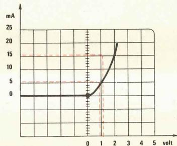
Fig. 7 Per un diodo rivelatore al germanio abbiamo una caduta irrisoria se la corrente che scorre nel diodo risulta inferiore a 1 mA; tale caduta però sale a 1 volt con correnti di circa 5 mA e a 2 volt con 15 mA.
