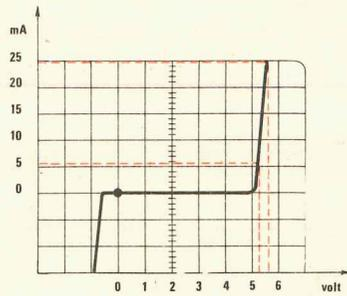
**Fig. 12** Questo diodo avendo la linea verticale molto più ripida del precedente (fig. 11) ci conferma che facendo scorrere attraverso ad esso 5 mA, stabilizza la tensione a 5,1 volt, ma anche se aumentassimo la corrente a circa 25 mA, le variazioni massime risulterebbero di soli 0,2 volt (cioè 5,4 volt).
