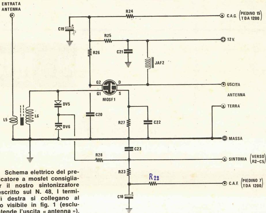
Fig. 2 Schema elettrico del pre-amplificatore a mosfet consigliato per il nostro sintonizzatore FM descritto sul N. 48. I terminali di destra si collegano al circuito visibile in fig. 1 (esclusa s'intende l'uscita « antenna »).
