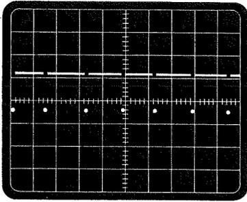
**Fig. 5** Impulsi negativi necessari per ottenere le righe orizzontali che potremo rilevare sul piedino 12 dell'integrato IC10.
