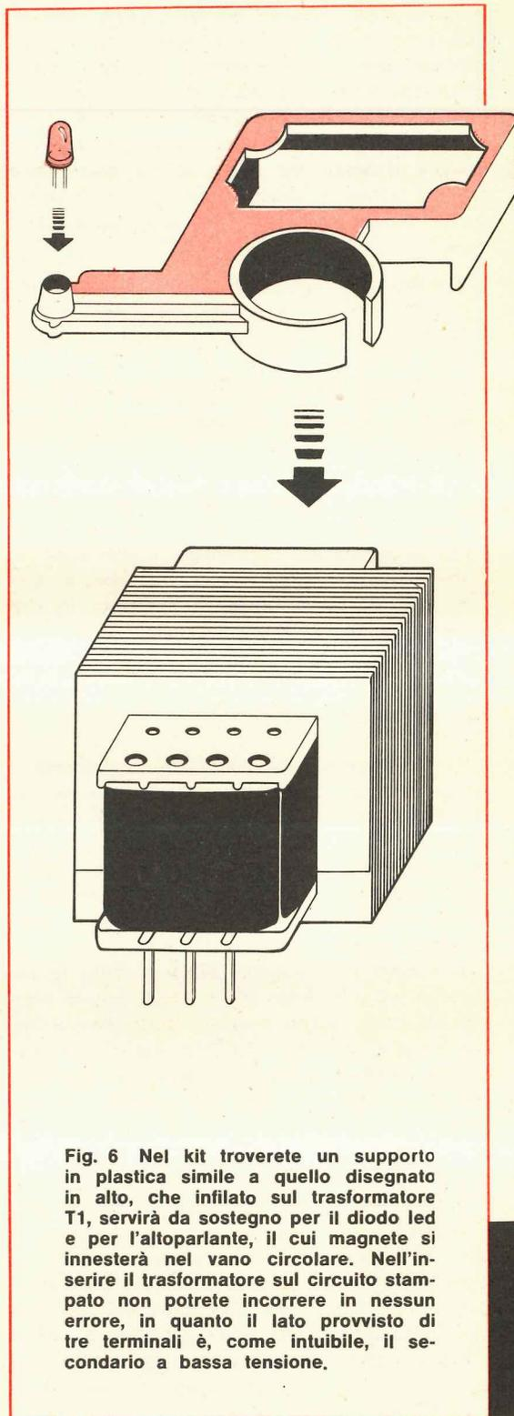
Fig. 6 Nel kit troverete un supporto in plastica simile a quello disegnato in alto, che infilato sul trasformatore T1, servirà da sostegno per il diodo led e per l'altoparlante, il cui magnete si innesterà nel vano circolare. Nell'inserire il trasformatore sul circuito stampato non potrete incorrere in nessun errore, in quanto il lato provvisto di tre terminali è, come intuibile, il secondario a bassa tensione.
