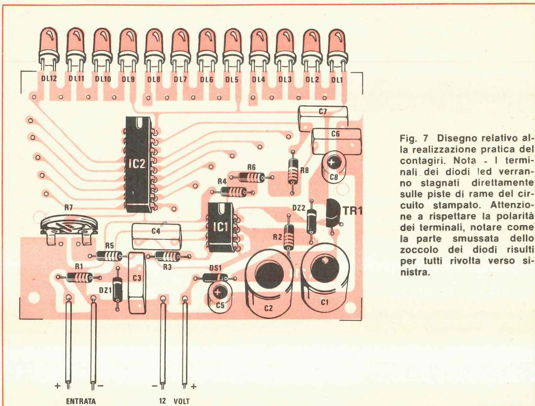
Fig. 7 Disegno relativo alla realizzazione pratica del contagiri. Nota - I terminali dei diodi led verranno stagnati direttamente sulle piste di rame del circuito stampato. Attenzione a rispettare la polarità dei terminali, notare come la parte smussata dello zoccolo dei diodi risulti per tutti rivolta verso sinistra.
