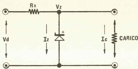
**Fig. 14** Come spiegato nell'articolo, per far scorrere attraverso il diodo zener la corrente più idonea per la miglior stabilizzazione, è necessario conoscere quanti milliamper assorbirà il carico che dovremo stabilizzare.
