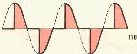
Fig. 3 Se tale tempo viene maggiorato a metà periodo, in uscita rileveremo metà tensione, cioè 110 volt anziché 220 volt, in quando sfrutteremo metà della semionda.
