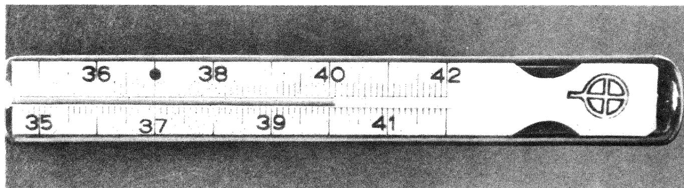
**Utilizzando il nuovissimo integrato UAA180 della Siemens è possibile realizzare degli interessanti strumenti di misura a diodi led, quali ad esempio il termometro che oggi vi presentiamo.**
