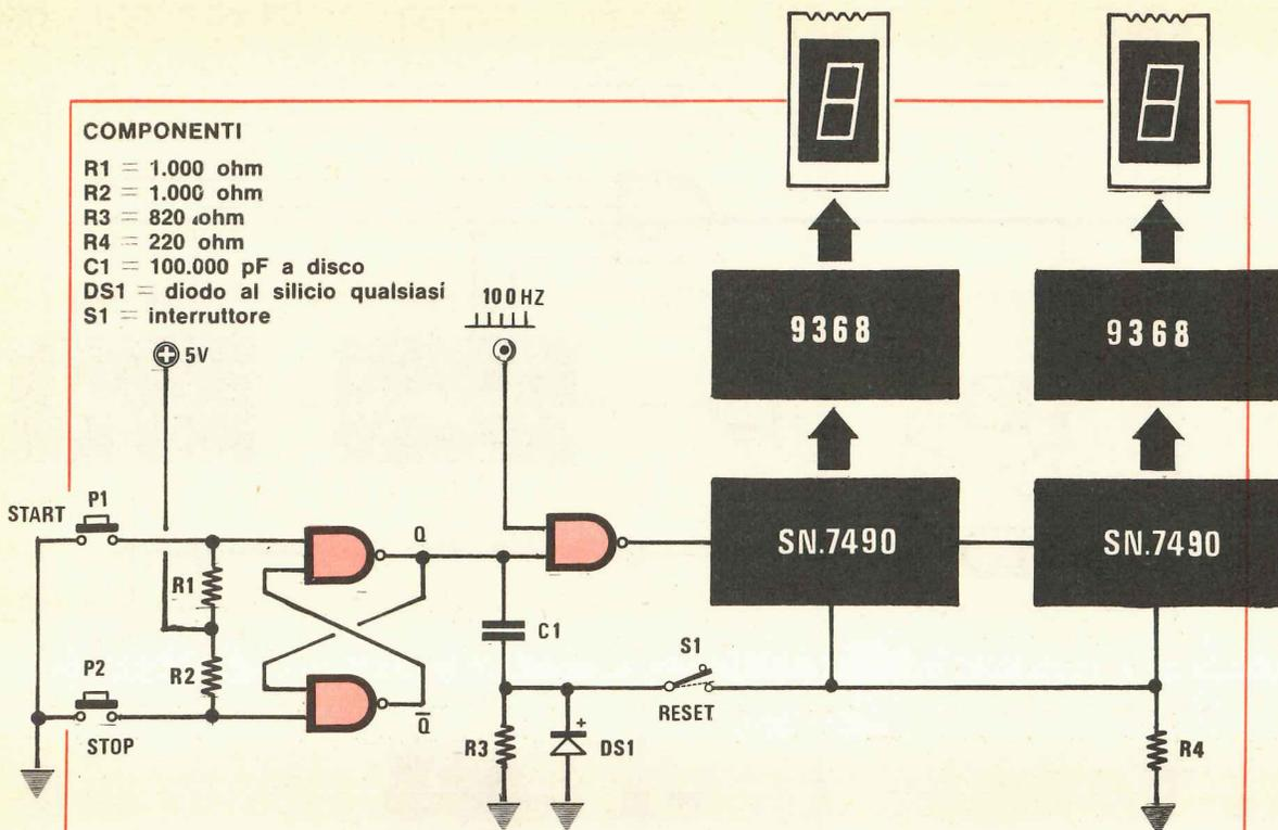
Fig. 15 Se invece vogliamo realizzare un circuito di cronometro che possa a nostro piacimento, resettare il conteggio precedentemente visualizzato quando pigiamo lo start, oppure far sì che lo addizionali al precedente dovremo aggiungere al circuito un semplice interruttore, e collegare tra i terminali di reset dei SN7490 e la massa la resistenza R4.
