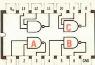
**Fig. 19** Disposizione dei vari nand e inverter nell'interno degli integrati.
