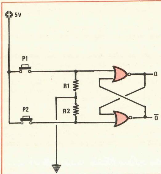
**Fig. 9** Se volessimo realizzare del flip-flop utilizzando dei NOR anziché dei Nand dovremo necessariamente collegare le due resistenze R1-R2 sui terminali d'entrata per mantenerli in condizione 0 e fornire tramite i due pulsanti la condizione logica 1.
