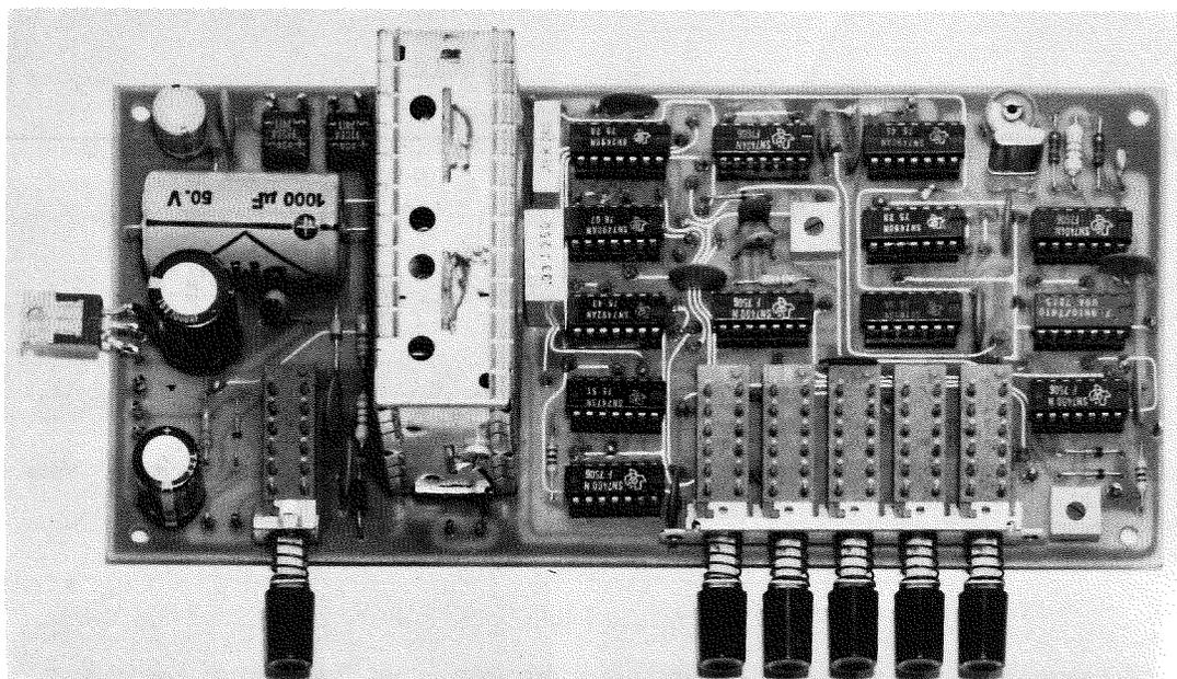
**Fig. 18** Come si presenta a costruzione ultimata il nostro generatore di barre. Si noti a sinistra l'integrato stabilizzatore ICI4 (uA.7805) che dovremo poi fissare sul piano orizzontale di alluminio del contenitore, in modo che quest'ultimo espliciti la funzione di aletta di raffreddamento.
