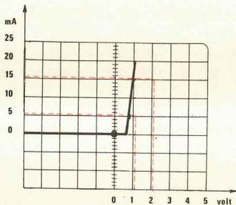
Fig. 6 Poiché ogni quadretto verticale corrisponde a 5 milliamper, se nel diodo al silicio scorrono correnti comprese tra 0 e 5 mA, si ha una caduta di tensione di circa 0,7 volt; con 15 mA si ha invece una caduta di circa 1 volt.
