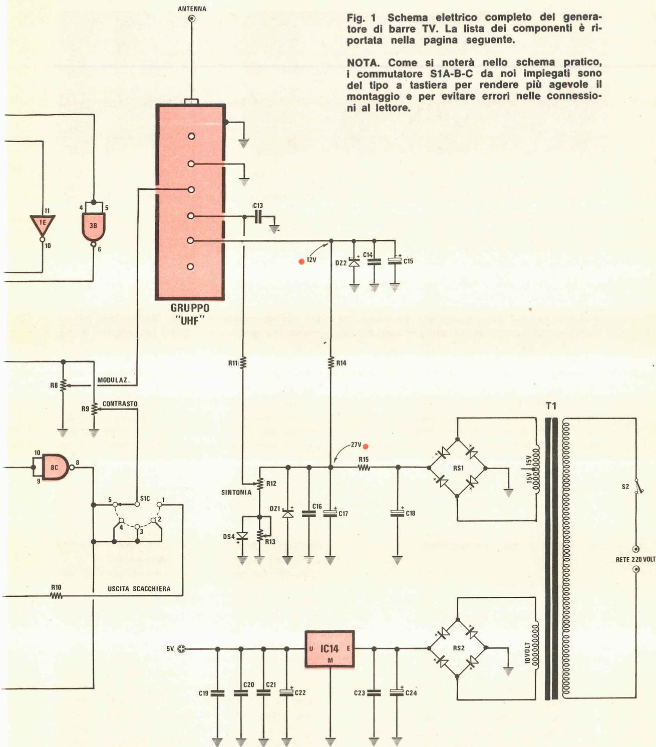
Fig. 1 Schema elettrico completo del generatore di barre TV. La lista dei componenti è riportata nella pagina seguente.
