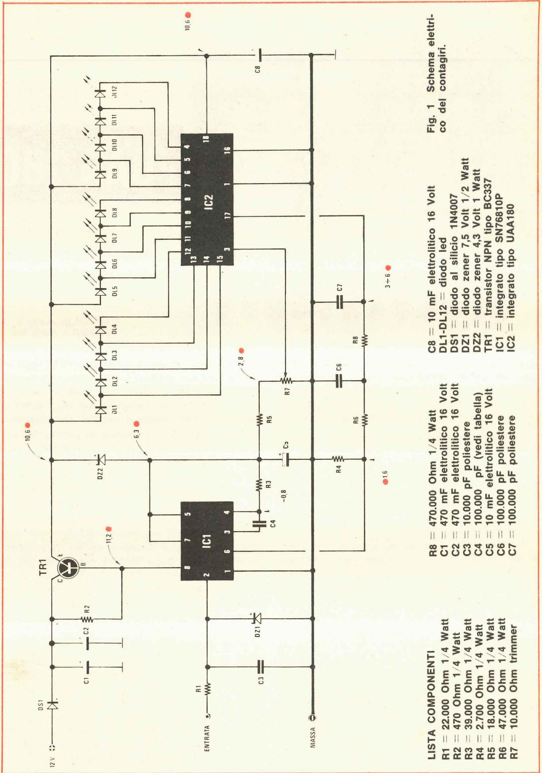
Fig. 1 Schema elettrico del contagiri.
