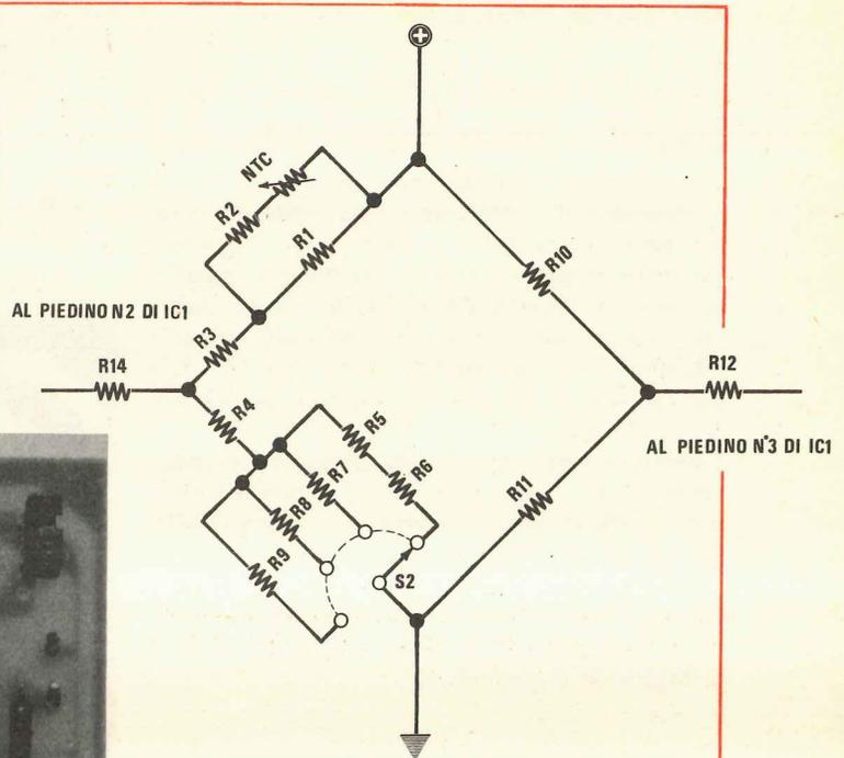
Fig. 4 Il circuito d'ingresso del nostro termometro è costituito in pratica da un ponte di Wheatstone che qui abbiamo ridisegnato in quanto nello schema elettrico di fig. 3 non è facilmente identificabile. Per semplificare il disegno i trimmer R6-R7-R8-R9 sono stati qui disegnati come normali resistenze fisse.
