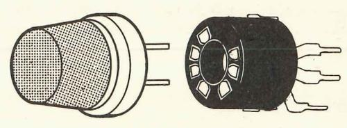
Fig. 5 La sonda rivelatrice di gas si innesterà nello zoccolo per valvola che salderemo sul circuito stampato. Nell'innestare la sonda controllate che i due terminali H-H risultino disposti dalla parte del fusibile F1.
