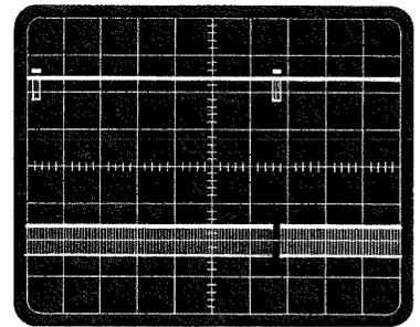
**Fig. 7** Pigiando il pulsante « righe verticali » sul cursore di R8 otterremo invece la figura che qui presentiamo.
