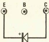
Fig. 1 Per controllare un diodo con il tracciacurve dovremo sfruttare le due sole boccole E-C, come del resto risulta anche disegnato sul pannello dello strumento.
