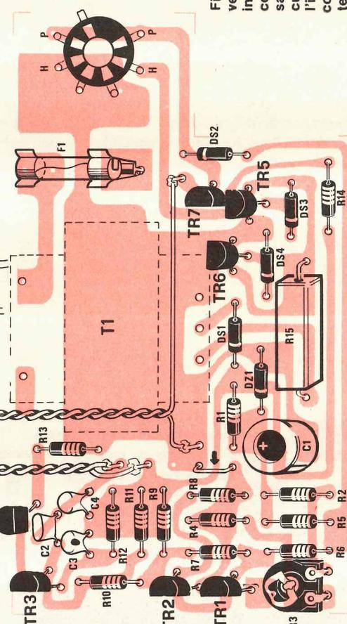
Fig. 4 Schema pratico di montaggio del segnalatore di gas. I due terminali del cordone di alimentazione (220 volt) andranno a collegarsi uno alla pista di rame cui fa capo un terminale del trasformatore T1 e l'altro su quello a cui è collegato il fusibile F1.
