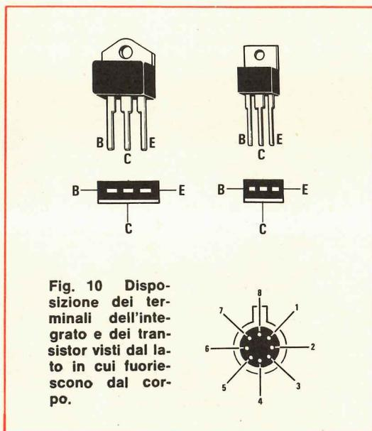
Fig. 10 Disposizione dei terminali dell'integrato e dei transistor visti dal lato in cui fuoriescono dal corpo.
