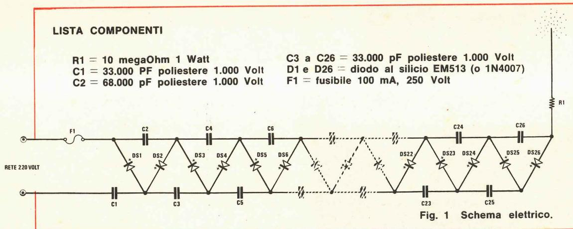
Fig. 1 Schema elettrico.
